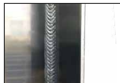
■ Saldatura a gola alluminio PF 3,0 mm | POWER.PULS (a doppio impulso)
