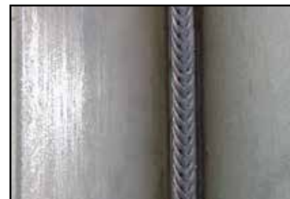
■ Saldatura a gola CrNi PF 5,0 mm | POWER.PULS (a doppio impulso)
