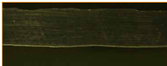
Saldatura di riparazione effettuata con DualWave. Quantità di pori notevolmente ridotta.
