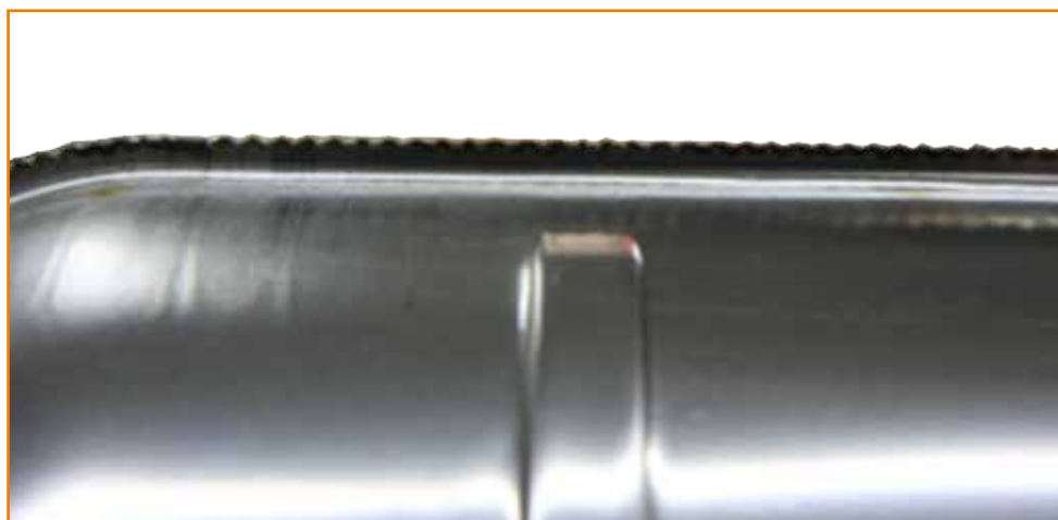
Serbatoio in acciaio inox con 250 punti di imbastitura
