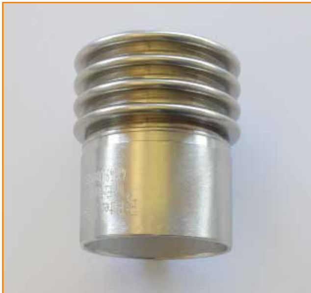
Saldatura circolare | cannello guidato a mano (3,0 mm su 0,2 mm)
