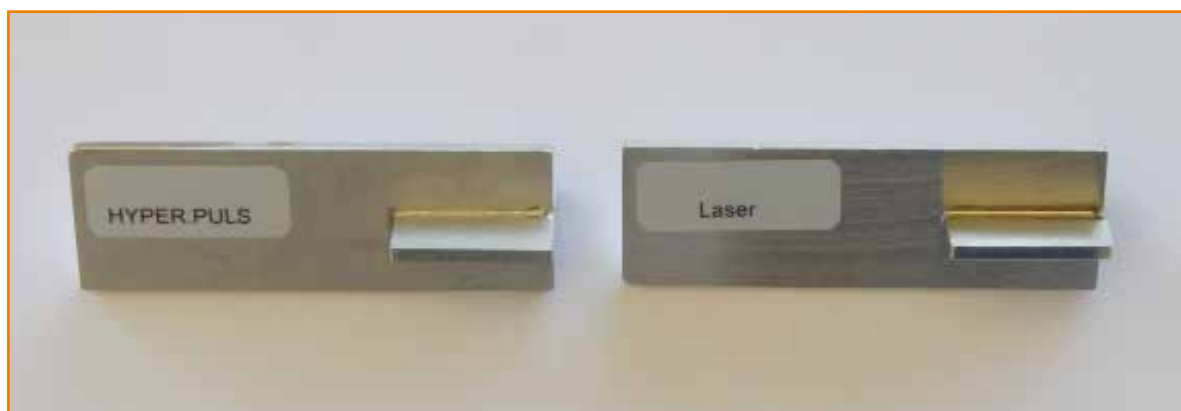
Saldatura angolare per la tecnologia farmaceutica | senza metallo di apporto, cannello guidato a mano
