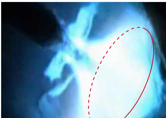
Finora: arco convenzionale Arco molto ampio con energia diffusa ai bordi
