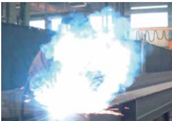
Finora: elevata produzione di fumi con l'arco convenzionale.
